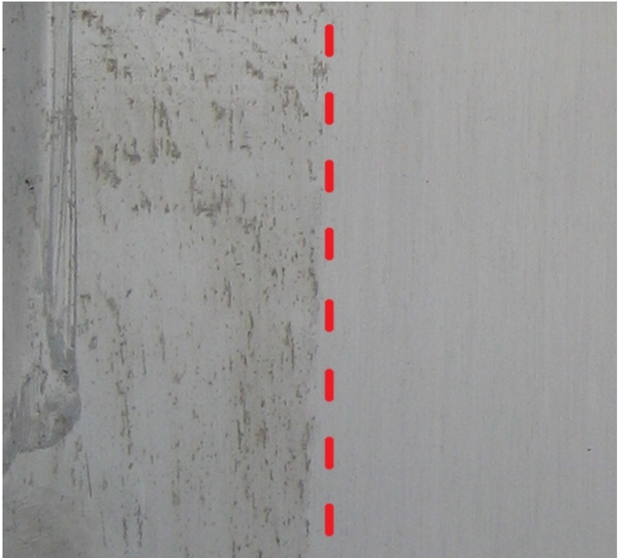
Abbildung 1: Edelstahloberfläche. Links verschmutzt oder mit falschem Mittel gereinigt. Rechts mit All Cleaner und Spezialschwamm in Bürstrichtung des Edelstahls gereinigt
